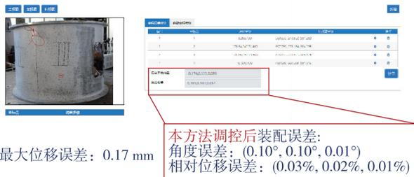
图 16 本方法最终装配误差 (直径 0.6 m 筒壳)
