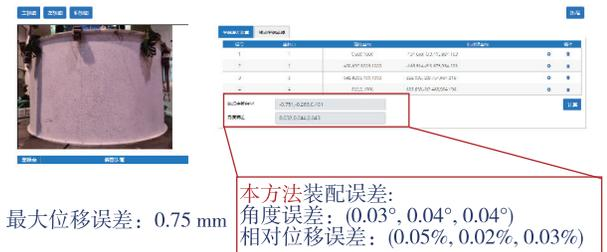
图 18 本方法最终装配误差 (直径 1.6 m 筒壳)
