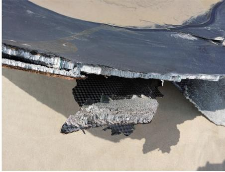
图 2 碳纤维蒙皮+铝蜂窝芯的夹层结构
