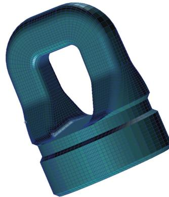
图 4 吊耳有限元模型
