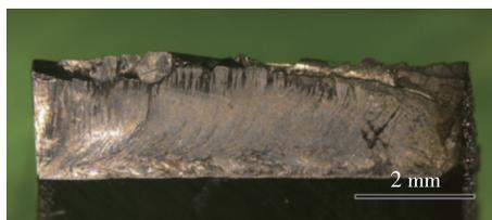
图 2 振动环境下金属断口形貌
