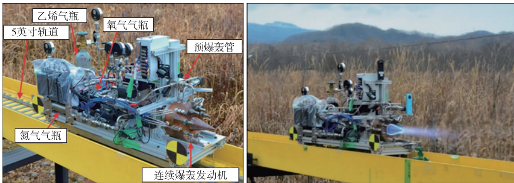
图 16 连续爆轰发动机火箭橇实验装置 [23]
