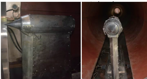
图 19 自由射流风洞中的模型发动机
