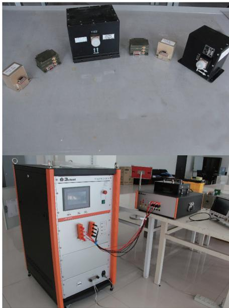
图 1 雷电间接效应抗扰度试验现场照片
