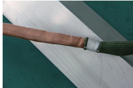
图 10 三同轴法电缆屏蔽效能测试
