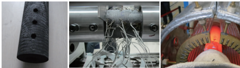
图8 复合材料典型圆轴的开孔连接以及常温、高温承载试验
