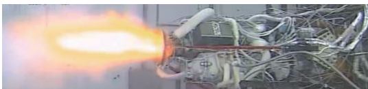
图 7 点火瞬间推力室出口火焰
