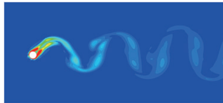
图 9 流速 1.7 m/s 时普通圆柱的涡量云图
