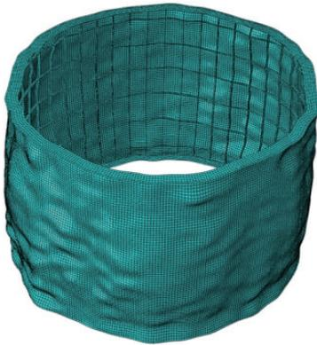
图 5 含几何缺陷有限元模型 (放大 60 倍)
