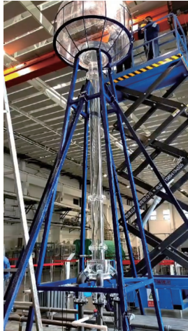
图 12 出流缩比原理性试验系统现场
