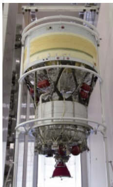
图 4 Delta 4 二级结构
