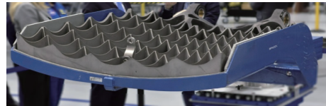
图7 局部后掠型栅格舵的代表——Falcon火箭子级再入控制舵面
