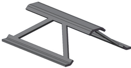
图 9 点阵芯子的单胞结构
