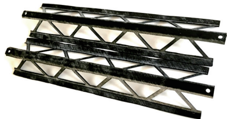
图 12 制备的 CF/PEEK 复合材料点阵芯子
