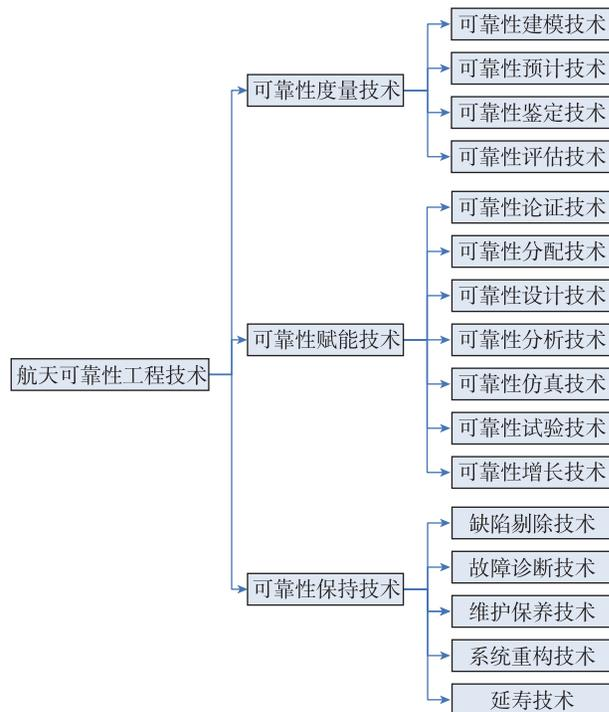
图 1 航天可靠性工程技术体系框架
