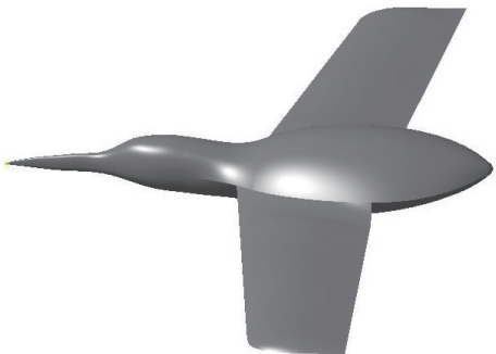
图13 跨介质航行器流体动力外形
