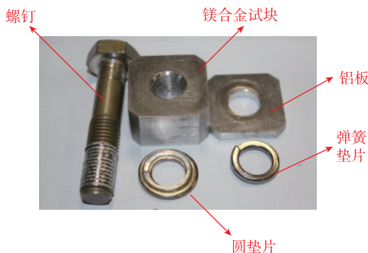
图 2 扭拉关系试验件
