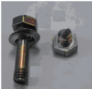
图 4 M6 试验件破坏形式
