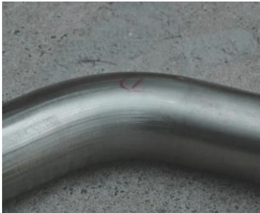
(b) 当 V_1 = V_2 时起皱消除
