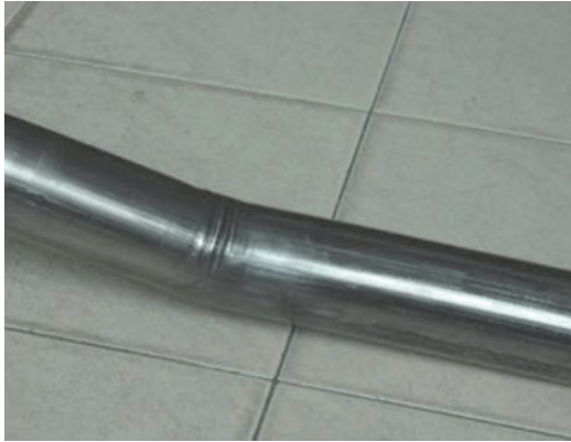
(a) 当 V_1 > V_2 时产生中部起皱
