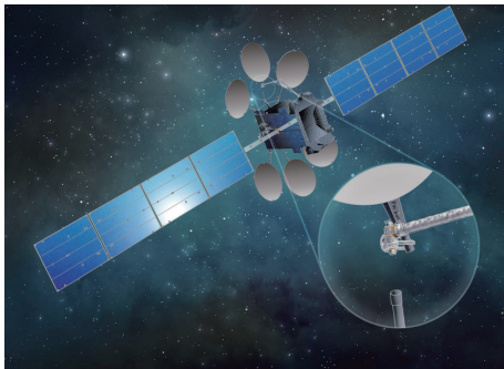
图 3 “蜻蜓”在轨自主装配天线
