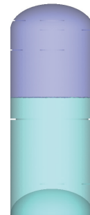
图2 液氢贮箱推进剂沉底前的极限状态, 液氢全部位于贮箱顶部
