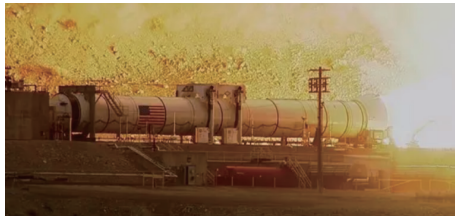
(b) 固体助推器热试车 (2015 年)
