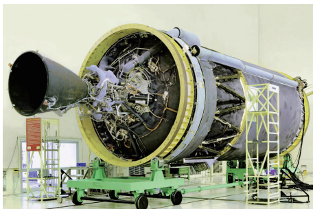
图12 C25低温上面级和CE-20发动机
