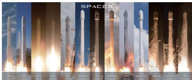
图 6 猎鹰 9 火箭构型更迭示意图 [2]
