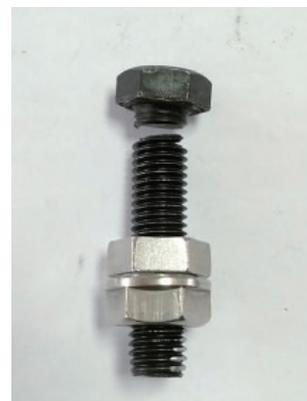
图 10 Hard-lock 螺母断裂失效
