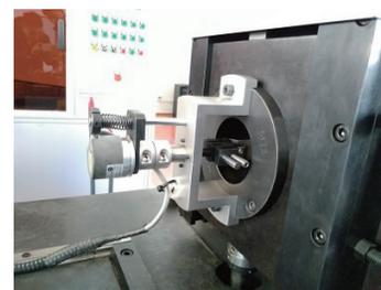
图3 螺母转角测量装置
