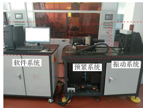
图1 FPL-200型紧固件横向振动试验机
