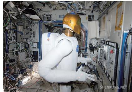
图2 Robonaut 2在国际空间站进行测试试验
