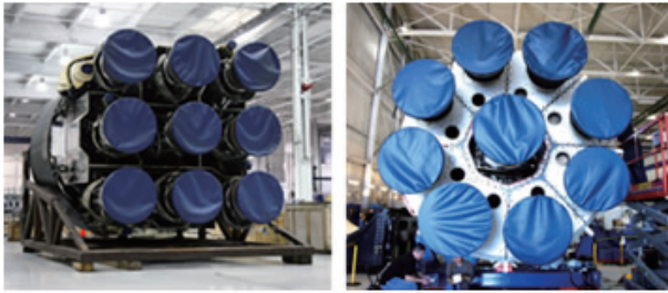
(a) v1.0 一子级发动机构型 (b) v1.1 一子级发动机构型
