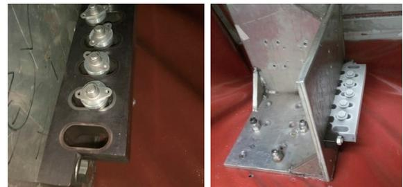
(a) 高温  $100^\circ\text{C}$  振动试验 (b) 低温  $-70^\circ\text{C}$  振动试验
